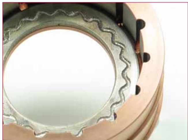
Abb. 9: Eine Kontaktscheibe aus Silber die mit einem Stator aus Kupfer mittels Elektronenstrahl gefügt ist.
