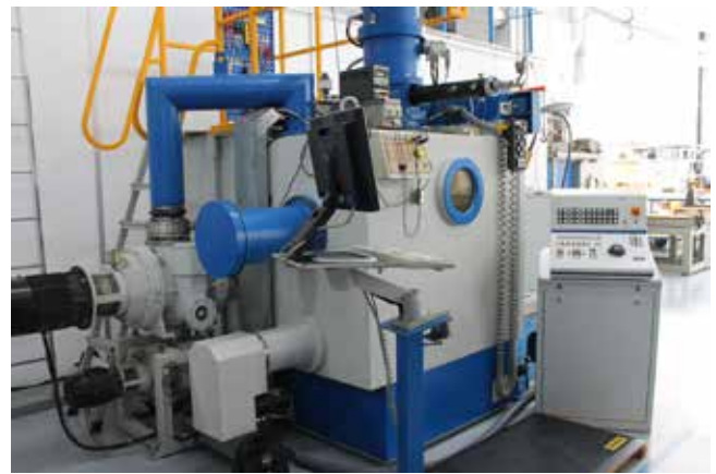
Abb. 2: NC-gesteuerte Elektronenstrahl-Schweissmaschine mit 150KV und 15 kW Leistung.
