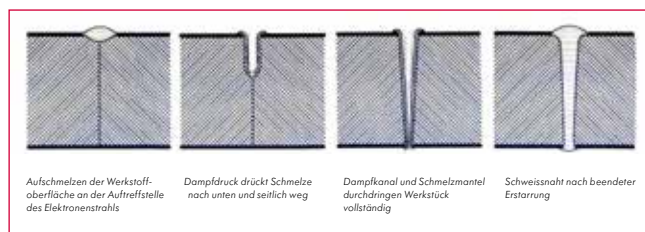
Abb. 6: Durch Schmelzen und Verdampfen kann der Strahl tief ins Material eindringen (Tiefenschweisseffekt) und in einem Arbeitsgang 100mm tiefe Nähte in Stahl erzeugen.
