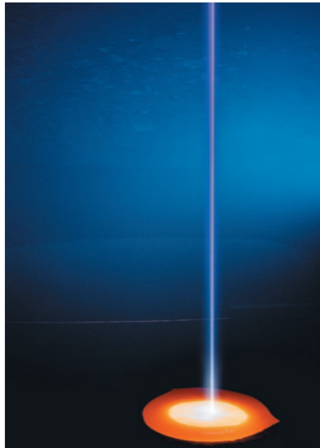
Abb. 4: Originalaufnahme eines Elektronenstrahls mit Schmelze, 12-fach vergrößert.
