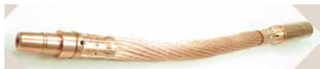
Abb. 10: Kupferanschluss in einer Tiefe von 25mm geschweisst. Der Elektronenstrahl erlaubt hier eine Schmelz-Verbindung, was mit anderen Verfahren technologisch nicht möglich wäre.
