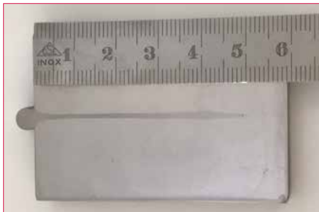
Abb. 7: Schliffbild mit einer 55mm tiefen Naht. Mit einem Breiten Tiefen Verhältnis von 1:50 werden Nahtbreiten erzielt, die im Vergleich zu WIG oder MAG Nähten etwa 2% der Breite entspricht.
