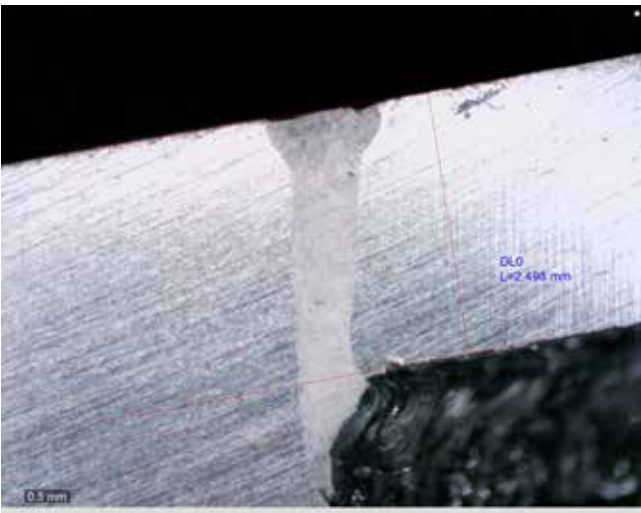
2,5 mm Schweisstiefe mit Unterraupe, Titan „Grad 4“
