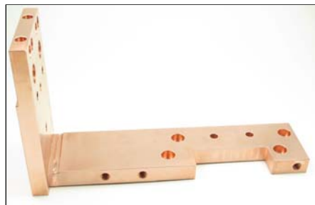
... und dann werden die 25 mm dicken Platten dicht am kompletten Querschnitt verschweisst.
