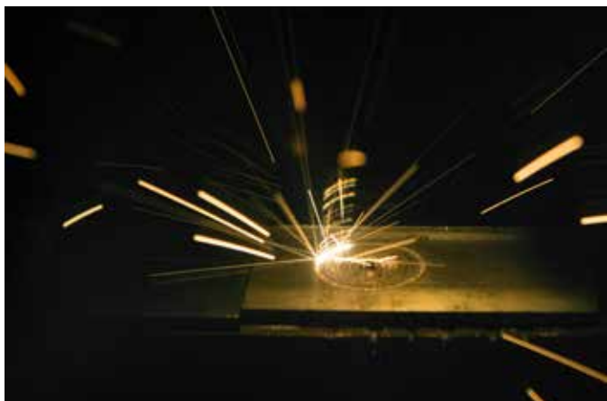
Simulationsschweissung: Der Elektronenstrahl schweisst auf einer Kupferplatte einzelne Kreissegmente (Schweisstiefe 28 mm).
