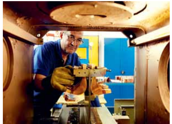
Der Schweissvorgang findet in einer Hochvakuumkammer statt.
